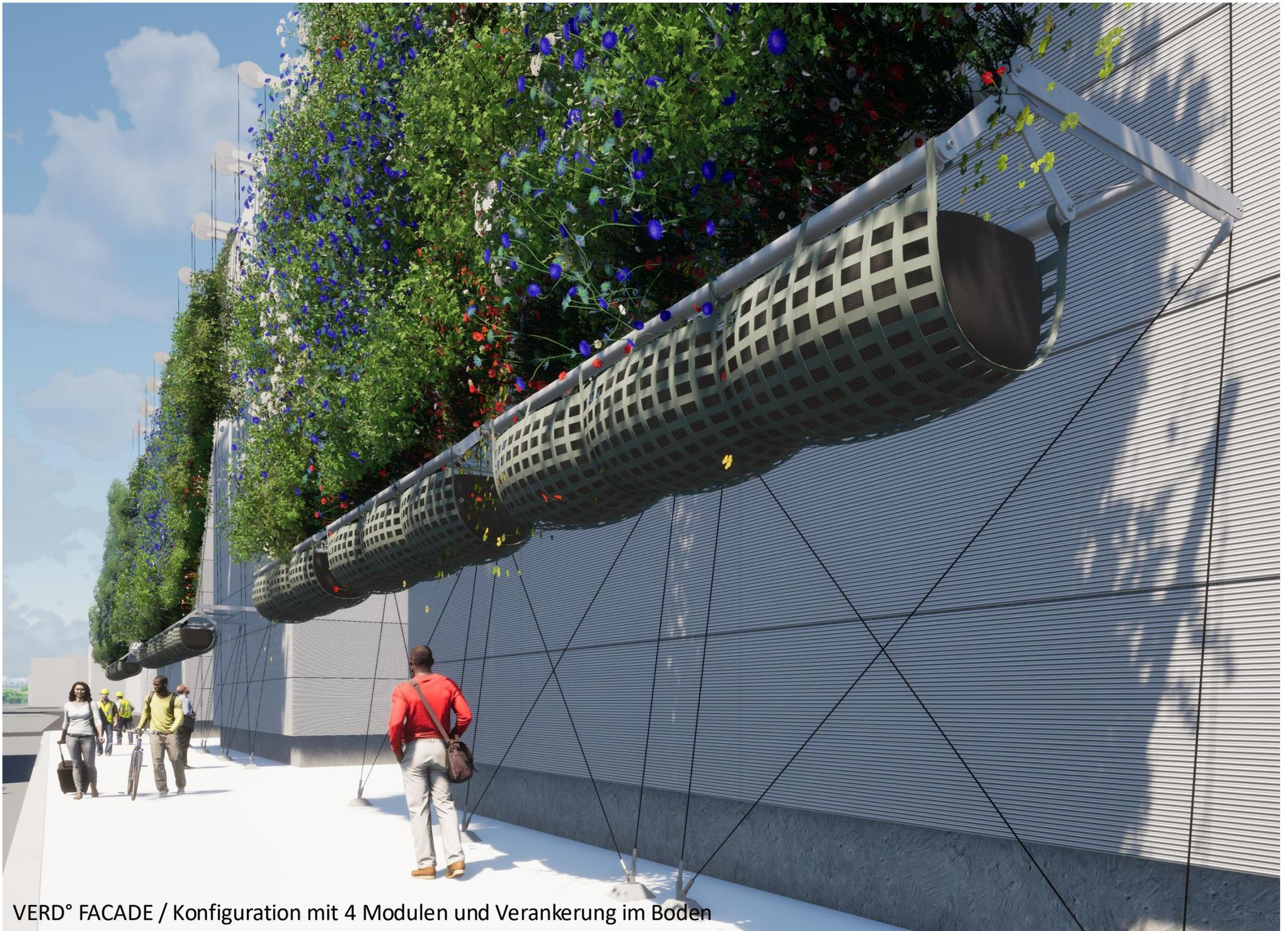
VERD° FACADE / Konfiguration mit 4 Modulen und Verankerung im Boden
